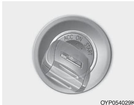
Vairas užsirakina, kad automobilis būtų apsaugotas nuo vagystės. Užvedimo raktelį galima ištraukti tik LOCK padėtyje. Sukdami užvedimo jungiklį į LOCK padėtį, ištumkite raktelį į vidų, kai jungiklis yra ACC padėtyje, ir pasukite raktelį į LOCK padėtį.
