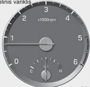
Tachometras rodo apytikrį variklio sūkių per minutę skaičių (rpm).
