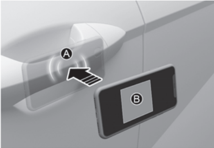
[A] Durelių rankenos autentifikavimo skydelis [B] NFC antena
