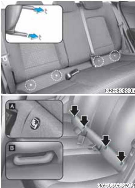
[A]: ISOFIX tvirtinimo įtaiso padėties ženklas [B]: ISOFIX tvirtinimo įtaisas
