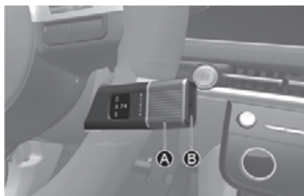
[A] Rotējošā pārnesumu pārslēgšanas ripa [B] P poga
