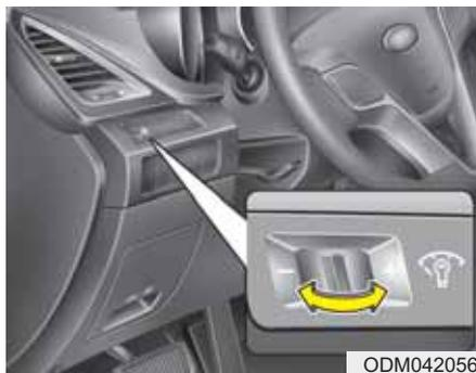
Instrumentu paneļa apgaismojuma spilgtumu regulē, pārvietojot apgaismojuma vadības pogu pa labi vai pa kreisi, kad aizdedzes slēdzis vai ieslēgšanas/izslēgšanas poga ir ieslēgtā stāvoklī (ON) vai ir ieslēgti aizmugures lukturi.
