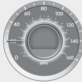
Spidometrs norāda braukšanas ātrumu un ir kalibrēts jūdzēs stundā (mph) un/vai kilometros stundā (km/h).
