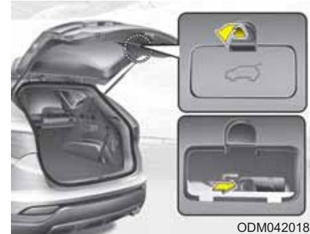
Jūsu automašīna ir aprīkota ar bagāžas nodalījuma atbloķēšanas sviru izmantošanai ārkārtas situācijās, kas atrodas bagāžas nodalījuma durvju apakšā. Ja kāds netīšām tiek ieslēgts bagāžas nodalījumā, bagāžas nodalījuma durvis var atvērt šādi:
