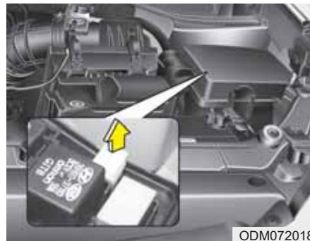
3. Izvelciet ārā šķietami bojāto drošinātāju, turot to taisni. Lietojiet izņemšanas instrumentu, kas atrodas dzinēja nodalījumā esošajā drošinātāju panelī.
