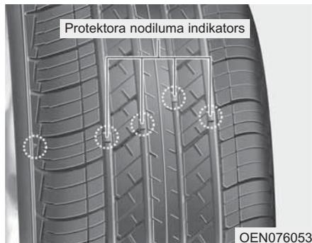
Ja riepa ir nodilusi vienmērīgi, protektora nodiluma indikators ir cieta lente apkārt protektoram. Tas liecina par to, ka protektora augstums no riepas ir mazāks nekā 1,6 mm (1/16 collas). Šādā gadījumā riepu nomainiet.
