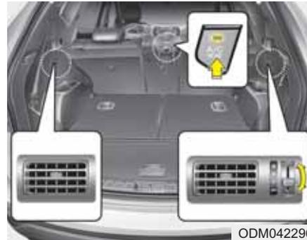
3. rindas gaisa kondicionēšanas vadības sistēmas ieslēgšana
