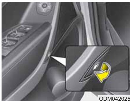
Degvielas uzpildes nodalījuma vāciņš jāatver no automašīnas iekšpuses, pavelkot uz augšu tā atvēršanas slēdzi, kas atrodas uz vadītāja durvīm.
