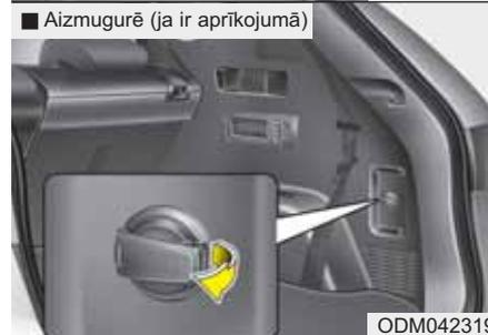
Elektrības ligzda ir paredzēta mobilo telefonu vai citu ierīču pieslēgšanai automašīnas elektrosistēmai. Ierīces, dzinējam darbojoties, drīkst patērēt mazāk nekā 10 ampērus.
