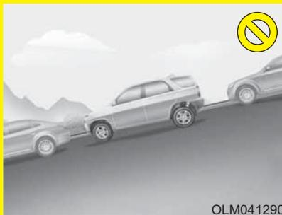
Novietojot automašīnu stāvēšanai slīpumā, vadītājam ir jāizmanto gāzes un bremžu pedāļi. Ja vadītājs nezina, ka ir jāizmanto gāzes un bremžu pedāļi, var notikt negadījums.
