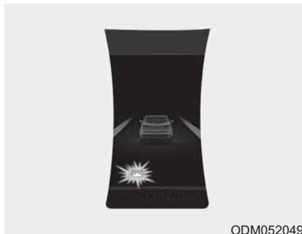
Lai lietotu LDWS, nospiediet pogu, kad dzinēja iedarbināšanas/izslēgšanas poga ir ON stāvoklī. Instrumentu blokā izgaismojas indikators. Lai LDWS atceltu, pogu nospiediet vēlreiz.
