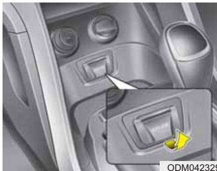
Ja Jūsu automašīna ir aprīkota ar aux un/vai USB (universālās seriālās kopnes) portu, Jūs varat izmantot aux portu, lai pieslēgtu audio ierīces un USB portu, lai pieslēgtu USB.
