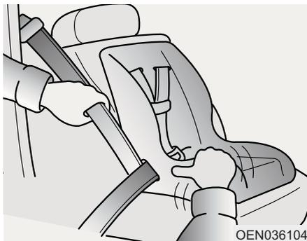
3. Piesprādzējiet drošības jostu un ļaujiet drošības jostai ievilkties, lai tā nebūtu vaļīga. Pēc bērnu sēdekliša uzstādīšanas mēģiniet to pakustināt visos virzienos, lai pārliecinātos, ka bērnu sēdeklišis ir stingri nostiprināts.
