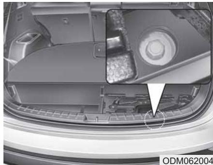
Rezerves riepa atrodas zem automašīnas, tieši zem bagāžas nodaļuma. Lai izņemtu rezerves riepu:
