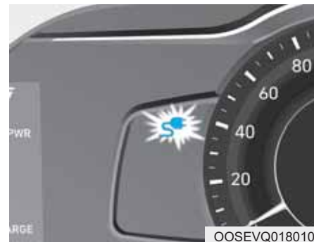
10. Pārbaudiet, vai ieslēdzas augstsprieguma uzlādes gaismas indikators instrumentu blokā. Uzlāde nenotiek, kad uzlādes gaismas indikators ir izslēgts.
