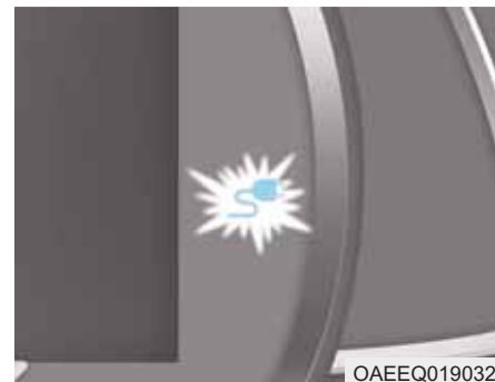
9. Pārbaudiet, vai ieslēdzas augstsprieguma akumulatora uzlādes gaismas indikators instrumentu blokā. Uzlāde nenotiek, kad uzlādes gaismas indikators ir izslēgts. Ja uzlādes savienojums nav pievienots kā pienākas, pievienojiet uzlādes kabeli atkārtoti, lai sāktu uzlādi.
