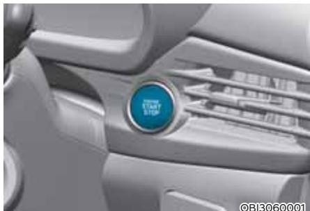
Atverot priekšējās durvis, dzinēja iedarbināšanas/izslēgšanas poga izgaismosies un nodzīsīs 30 sekundes pēc durvju aizvēšanas. (ja ir aprīkojumā)
