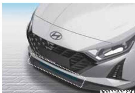
Aktīvais gaisa atloks uzrauga gaisa atloku zem priekšējā bampera, lai dzesētu automašīnas daļas un uzlabotu degvielas patēriņa efektivitāti.
