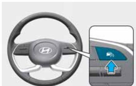
Nospiediet braukšanas palīgsistēmu pogu (**LIMIT**), lai izslēgtu manuālo ātruma ierobežojuma palīgsistēmu. Manuāla Ātruma ierobežojuma palīgsistēmas (**LIMIT**) indikators izslēgsies.
