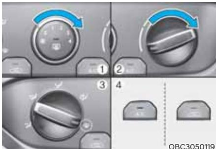
1. Ventilatora ātrumu iestatiet augstākājā (līdz galam pa labi) režīmā.
