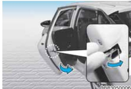
Ārkārtas situācijā (ja ir izlādējies akumulators u.tml.), durvis var aizslēgt manuāli ar ārkārtas atslēgu.
