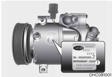
Kompresora markējums ietver informāciju par kompresoru, kas uzstādīts jūsu automašinā, piemēram, modeli, piegādātāja detaļas numuru, ražošanas numuru, dzesētāju (1) un dzesētāja eļļu (2).
