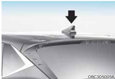
"Haizivs spuras" antena uztver pārraidītos datus. (PIEMĒRAM: GPS)
