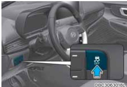
Elektroniskās stabilitātes kontroles (ESC) sistēma ir paredzēta, lai stabilizētu automašīnu, kad tā brauc līkumā.
