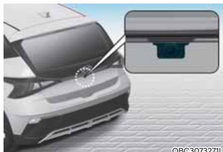
Izvērstā atpakaļskata kameras izmanto kā konstatēšanas sensoru, lai konstatētu gājējus. Ja lēcu klāj sniegs, lietus vai kaut kas cits, var paslītināties kameras darbības efektivitāte, un atpakaļgaitas stāvvietas sadursmes novēršanas palīgsistēma var nedarboties kā pienākas. Kameras lēcā vienmēr ir jābūt tīrai.
