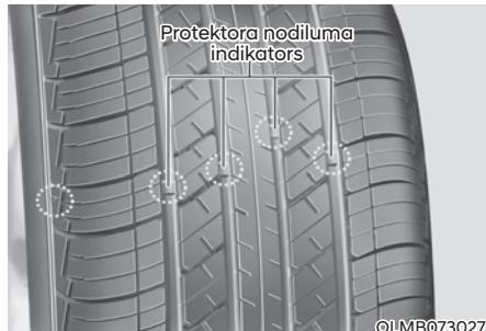
Ja riepa ir nodilusi vienmērīgi, protektora nodiluma indikators ir cieta lente apkārt protektoram. Tas liecina par to, ka protektora augstums no riepas ir mazāks nekā 1,6 mm. Šādā gadījumā riepu nomainiet. Pirms riepas nomaiņas negaidiet, kamēr lente parādās visa protektora platumā.
