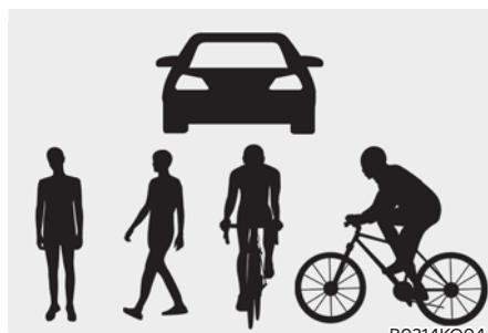
Augstāk esošajā attēlā ir parādīts, ko priekšējā kamera atpazīst kā transportlīdzekli, gājēju vai velosipēdistu.
