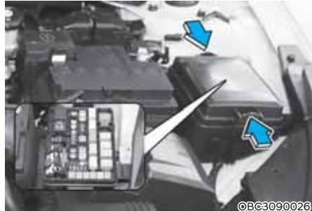
5. Izvelciet ārā šķietami bojāto drošinātāju, turot to taisni. Lietojiet izņemšanas instrumentu, kas atrodas dzinēja nodalījumā esošajā drošinātāju panelī.
