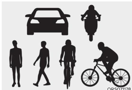
Augstāk esošajā attēlā ir redzams attēls, kuru priekšejā kamera un priekšējais radars spēj konstatēt kā automašīnu, divriteņu mehānisko transportlīdzekli, gājēju un velosipēdistu.
