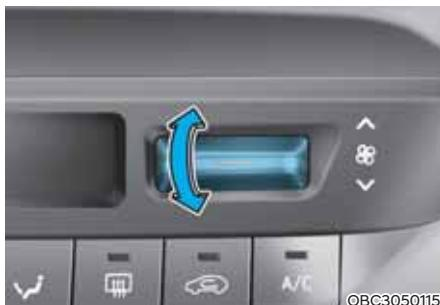
Lai palielinātu ventilatora ātrumu un gaisa plūsmu, piespiediet slēdzi uz augšu. Lai samazinātu ventilatora ātrumu un gaisa plūsmu, piespiediet slēdzi uz leju.
