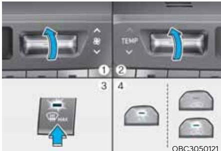
1. Ventilatora ātrumu iestatiet augstākajā režīmā.
