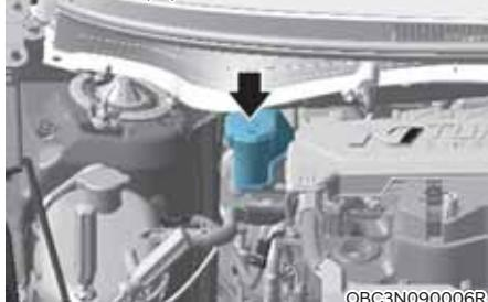
Periodiski pārbaudiet šķidruma līmeni tvertnē. Šķidruma līmenim tvertnē jābūt starp atzīmēm "MAX" un "MIN", kas atrodamas uz tvertnes sāniem.
