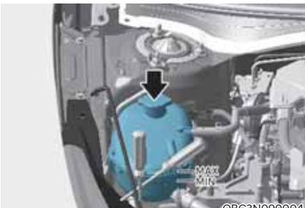
Pārbaudiet visu dzesēšanas sistēmas šķūtenu un sildītāja šķūtenu stāvokli un savienojumus. Nomainiet īkvienu šķūteni, kas mainījusi formu vai ir bojāta.
