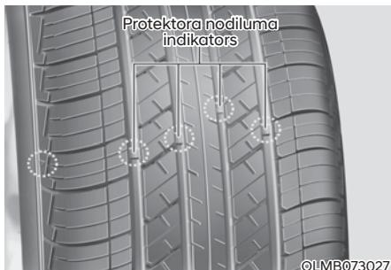
Ja riepa ir nodilusi vienmērīgi, protektora nodiluma indikators ir cieta lente apkārt protektoram. Tas liecina par to, ka protektora augstums no riepas ir mazāks nekā 1,6 mm. Šādā gadījumā riepu nomainiet. Pirms riepas nomaiņas negaidiet, kamēr lente parādās visa protektora platumā.
