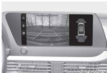
Pieskaroties iekrānā tiek attēlots skats no augšas un attālums līdz transportlīdzeklim aiz Jūsu automašīnas, novietojot automašīnu stāvvietā.
