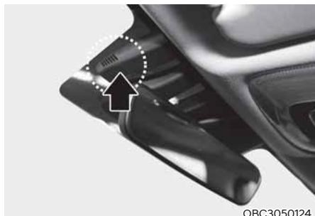
Automātiskā stiklu aizsvīšanas novēršanas sistēma palīdz mazināt vējstikla aizsvīšanas iespējamību, automātiski sajūtot mitrumu vējstikla iekšpusē.
