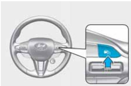
Nospiediet braukšanas palīgsistēmu pogu ( ), lai izslēgtu manuālo ātruma ierobežojuma palīgsistēmu. Manuālās ātruma ierobežojuma palīgsistēmas iespējošanas indikators ( LIMIT) nodzīsīs.
