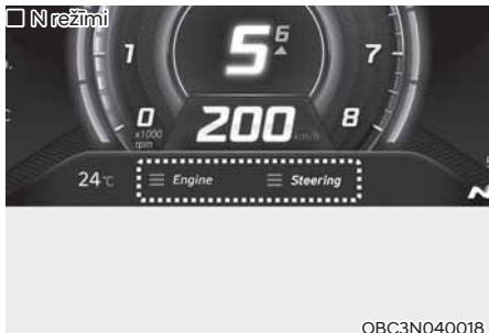
CUSTOM režīma galvenie iestatījumi ir uzrādīti instrumentu paneļa apakšdaļā. CUSTOM režīms var tikt izvēlēts informatīvi izklaidējošajā sistēmā.
