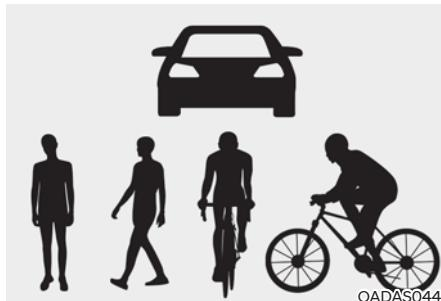
Augstāk esošajā attēlā ir parādīts, ko priekšējā kamera atpazīst kā transportlīdzekli, gājēju un velosipēdistu.
