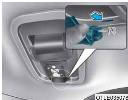
4. Pistke keeleplaat (A) turvavöö mehhanismi kattes olevasse avasse.
