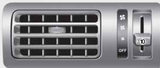
■ Kolmanda istmerea ventilatsioonisüsteemi juhtpaneel (B-tüüpi kliimaseade)
