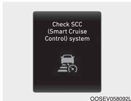
„Check SCC (Smart Cruise Control) system“ (Kontrollige intelligentset isekohanduvat kiirushoidikut)
