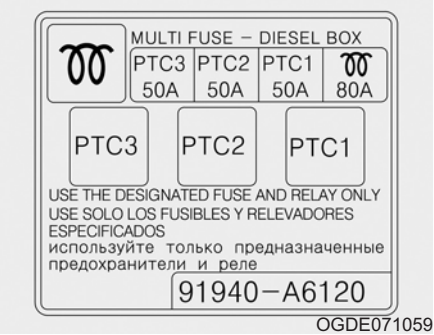
Täiendav kaitsmepaneel mootori- ruumis (ainult diiselmootoriga mudel)
