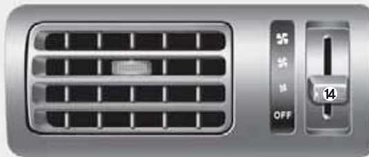
■ Kolmanda istmerea ventilatsioonisüsteemi juhtpaneel (A-tüüpi kliimaseade)
