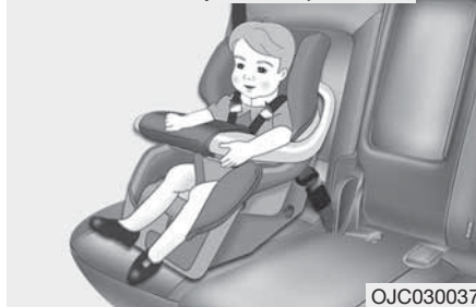
Lastenistuimen kiinnitys kasvot ajosuuntaan
