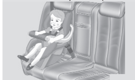
Lastenistuimen kiinnitys kasvot ajosuuntaan
