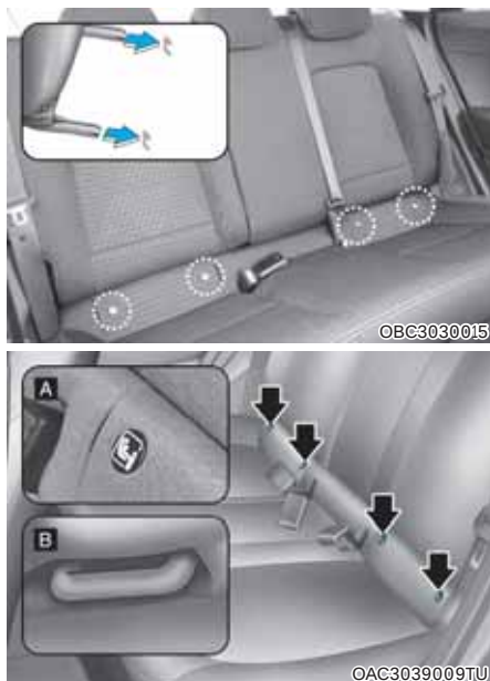
[A]: ISOFIX-kiinnityspisteen sijaintimerkintä, [B]: ISOFIX-alakiinnityspiste
