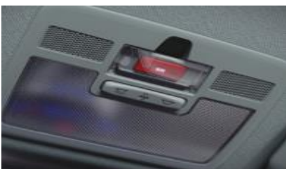
eCall - automaattinen hätä-puhelujärjestelmä
